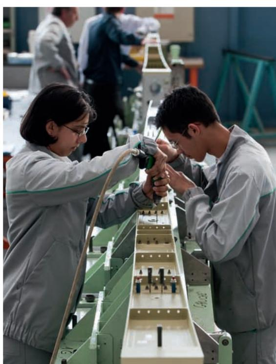
**Assemblage d'un bec de voilure de Rafale à Martignas**
