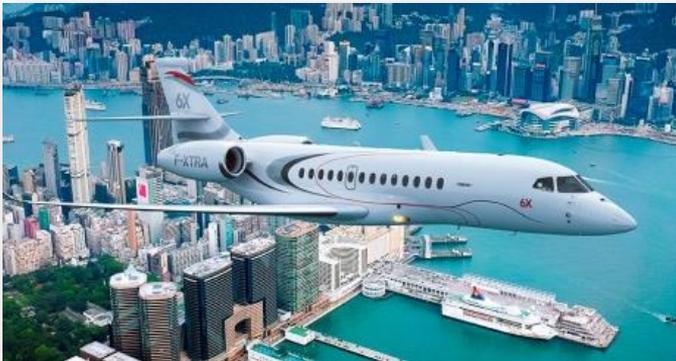
Le besoin des clients pour un avion long range et large cabine restant intact, Dassault Aviation a lancé le Falcon 6X équipé de moteurs Pratt & Whitney Canada (PW812), reprenant le diamètre du fuselage du Falcon 5X, avec un range de 5 500 NM et une entrée en service prévue en 2022.
