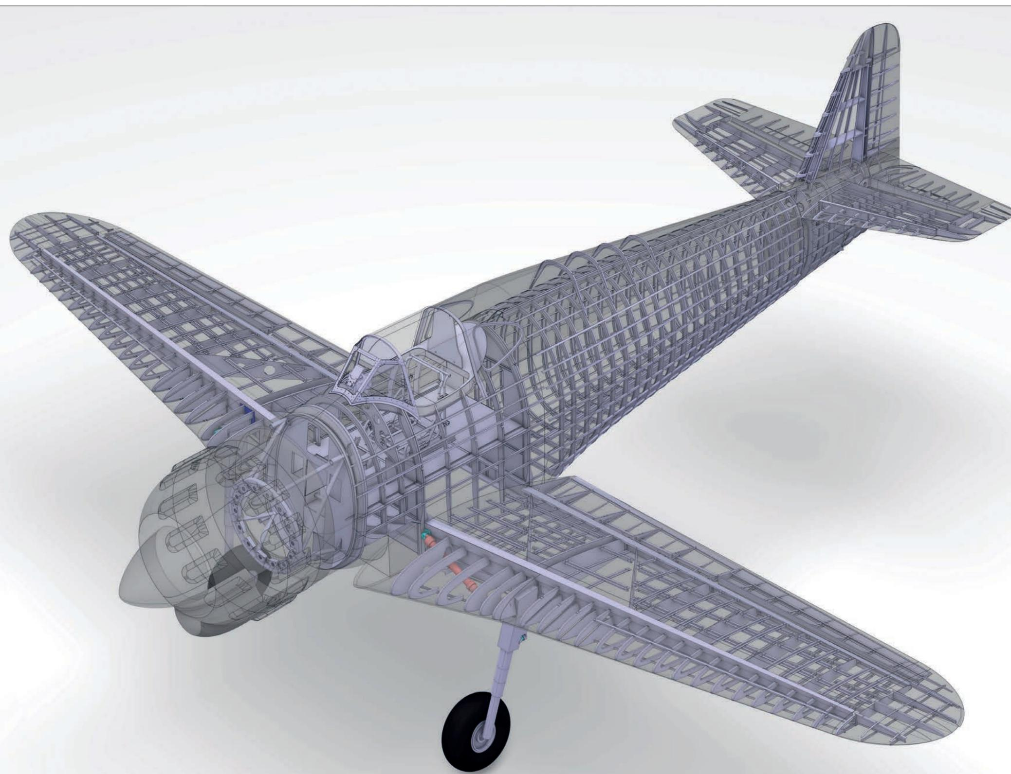
Image de la maquette numérique du MB.152 conçue par l'équipe bénévole du projet à l'aide du logiciel de conception Catia de Dassault Systèmes.
